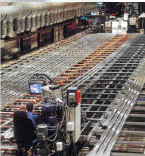
La extrusión se desliza sobre una bancada de enfriamiento.
